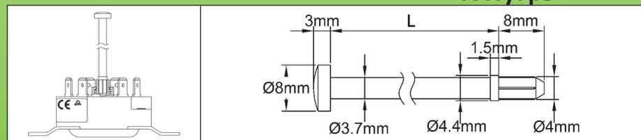
Стержни с ручным сбросом, работают на больших дистанциях
