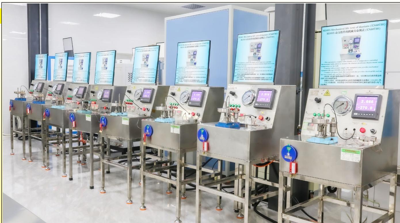
**Комплект автоматического оборудования для механического испытания диастатов на долговечность.**
