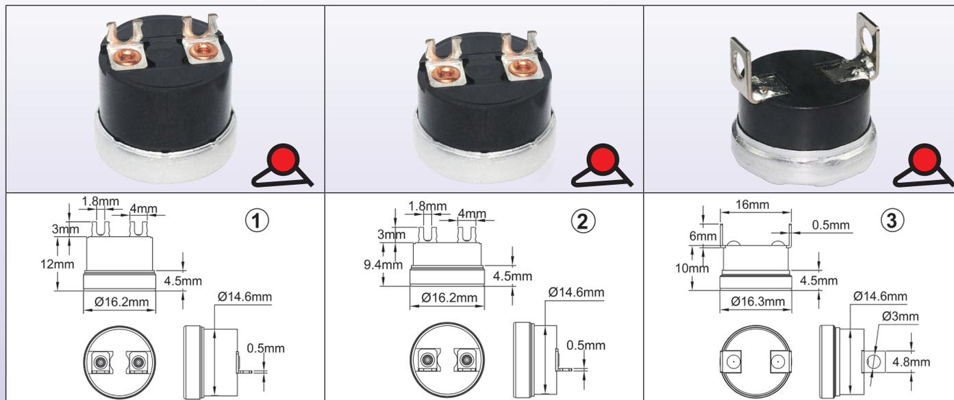
Этот дисковый термостат приспособлен для монтажа на конце кабеля, имеет клеммы под пайку малого размера и алюминиевую тарелку. Выдерживает силиконовые или эпоксидные наполнители. Термостат открывается при повышении температуры.
