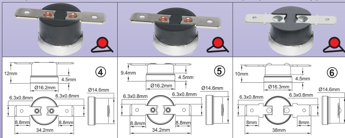
Термостат для защиты от замерзания, предназначен для монтажа на конце нагревательного кабеля под двустенной термоусадочной муфтой, со столбиковым выводом 6,3 × 0,8 и горизонтальным выступом, для быстроразъемных соединений или пайки. Алюминиевая термочувствительная тарелка. Контакт размыкается при повышении температуры.
