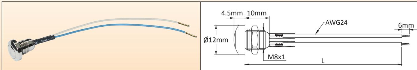
Проводной переключатель для ручного сброса. Требуется отверстие диам. 8 мм в монтажной плате. Длина проводов 100 мм. Другая длина по запросу.
