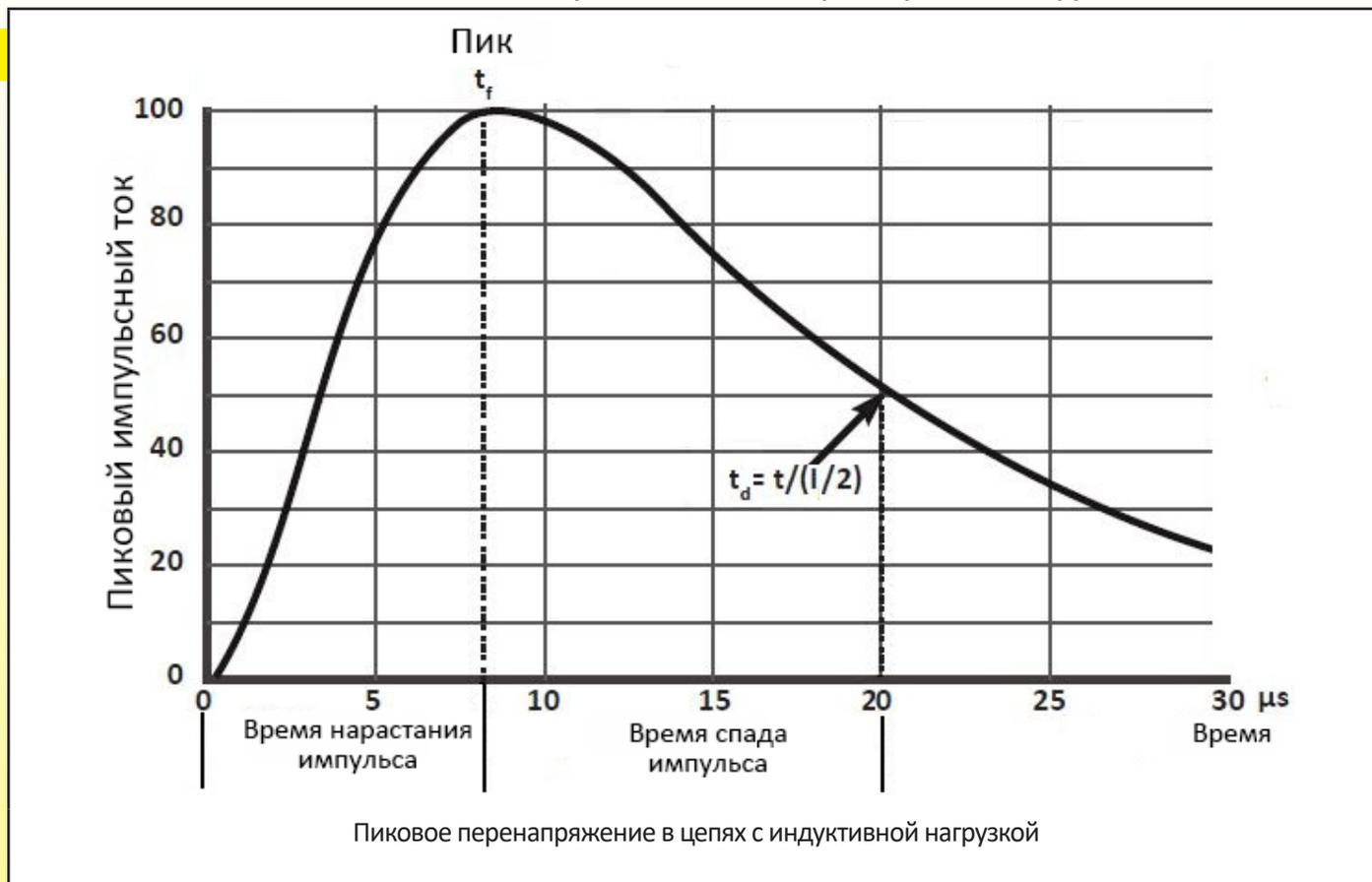
Когда выключатель разрывает индуктивную нагрузку, в контактной цепи выключателя возникает достаточно высокая противодействующая электродвижущая сила (противо-ЭДС). Чем выше противо-ЭДС, тем большим будет повреждение контактов.
