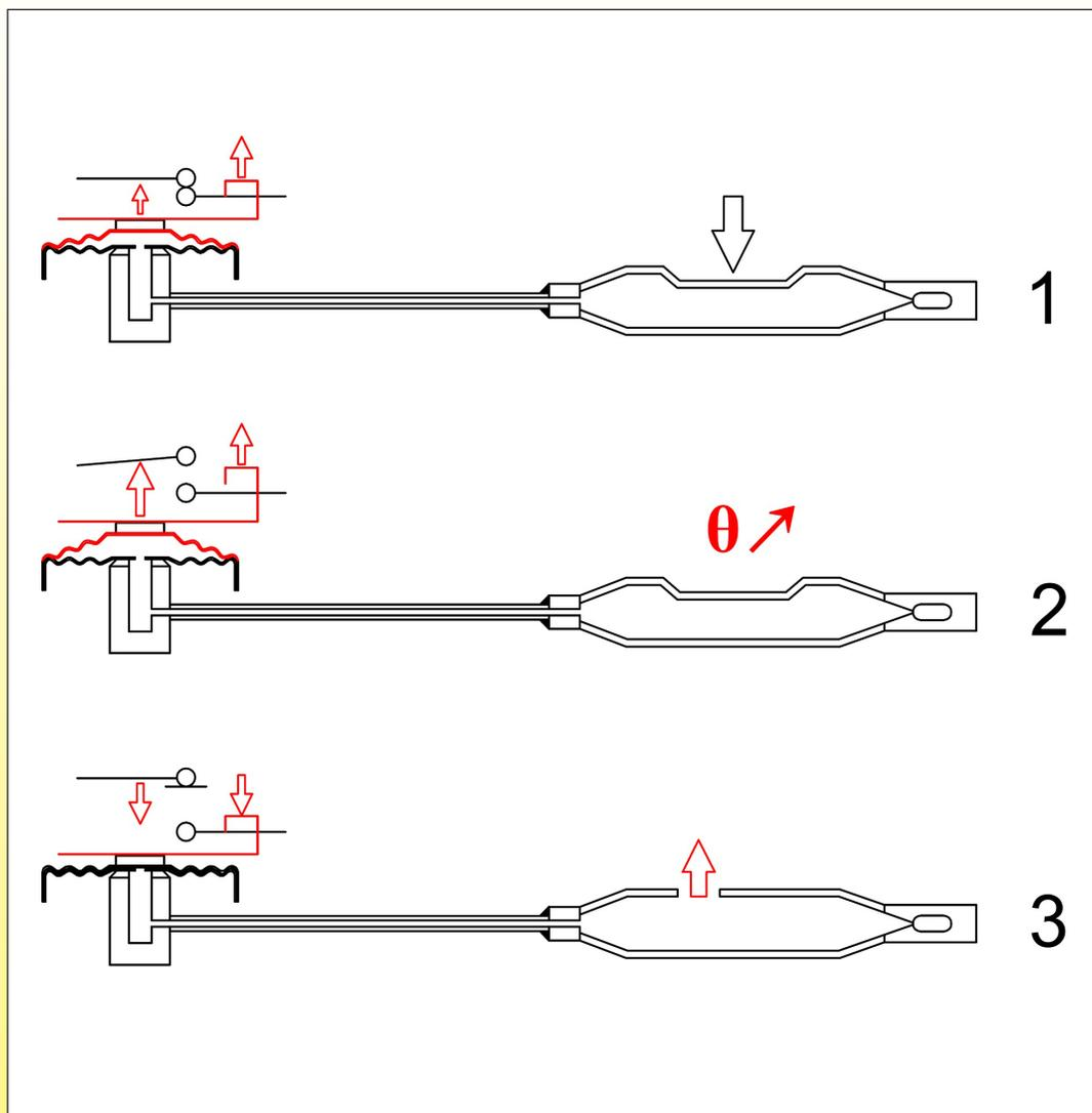
В этих системах после герметизации диастата при температуре окружающей среды по патрону наносится небольшой удар, вызывающий искусственное раздувание сильфона (1). Также можно выполнить ту же функцию, произведя герметизацию диастата при отрицательной температуре (-20,-30°C). Таким образом, сильфон продолжает сжиматься при температуре ниже комнатной.
