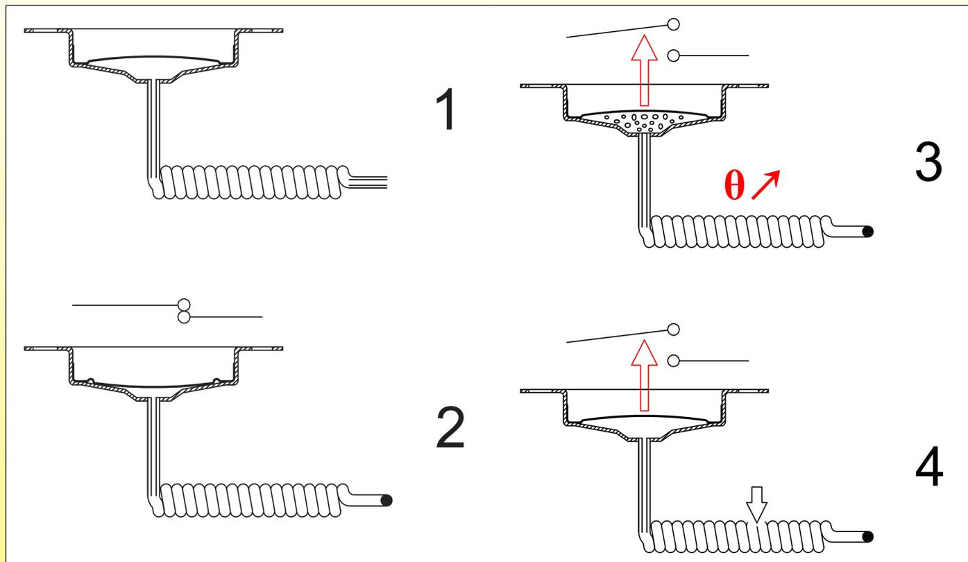
В системах отказоустойчивости кипящего типа сильфон диастата состоит из двух тарелок, по одной из которых бьют. Эта бьющаяся тарелка имеет выпуклую форму, как биметаллический диск, и переходит из выпуклой формы в вогнутую при воздействии силы. Диастат перед наполнением (1) сконструирован так, что тарелка в ненапряженном положении имеет выпуклость, направленную наружу.
