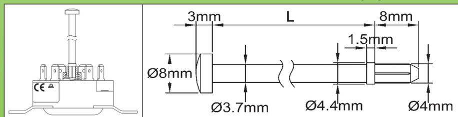
Стержни с ручным сбросом, работают на больших дистанциях
