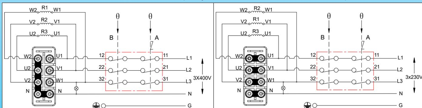
Источник питания 3 x 400 В с пилотной лампочкой 230 В даже при отсутствии нейтрального провода питания
